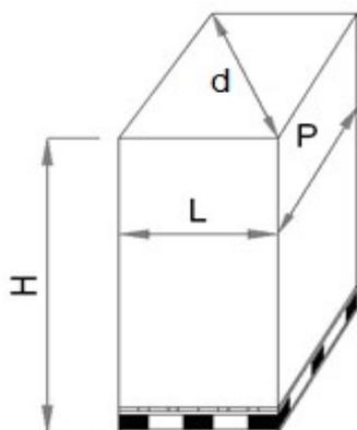
La profondità del pacco P è limitata a 2000 mm per una questione di miglior gestione della linea di movimentazione, anche se teoricamente non ha limiti. Il prodotto ha le misure massime indicate, a seconda della macchina, considerando che le misure minime di L e P sono di 500, mentre di H 600 mm. Se si ruota il pacco la diagonale (d) massima consentita corrisponderà a L max.
