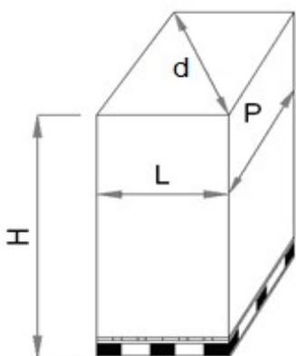
La profondità del pacco P è limitata a 2000 mm per una questione di miglior gestione della linea di movimentazione, anche se teoricamente non ha limiti. Il prodotto ha le misure massime indicate, a seconda della macchina, considerando che tutte le misure minime sono di 500 mm. Se si ruota il pacco la diagonale (d) massima consentita corrisponderà a L max.
